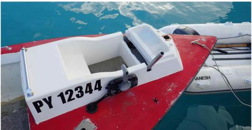
angebrachter Hebel steuert das Boot, die Motorschaltung liegt seitlich. Der Steuermann hat so die See vor sich voll im Blick, kann Schwimmern, Netzen und Korallenköpfen ausweichen.
